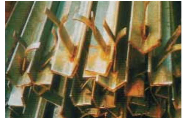
Fig. 3: Defectos en el recubrimiento galvanizado provocados por la escoria de soldadura no eliminada
