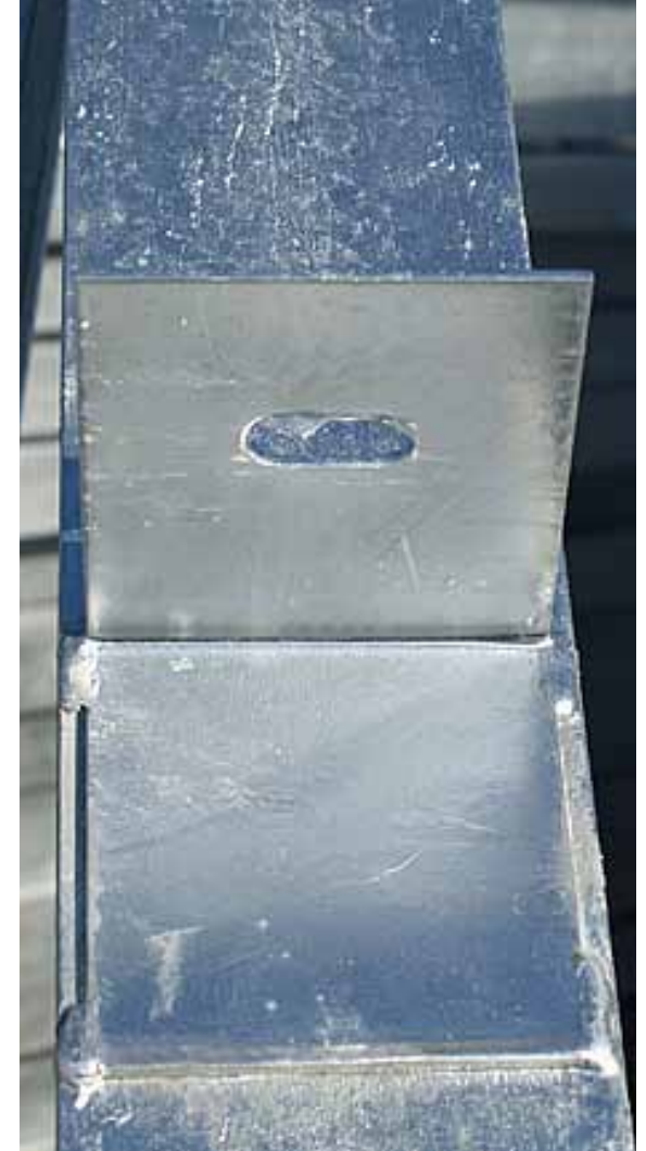
Fig. 1: Pieza de acero tras el proceso de galvanización
