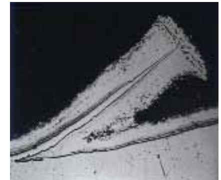
Fig. 6: Sección transversal de un pico formado por una estriación (x 2000).
