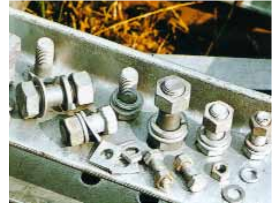
Fig. 2. Tornillos, tuercas y arandelas son los principales elementos de unión que deben ser galvanizados.
