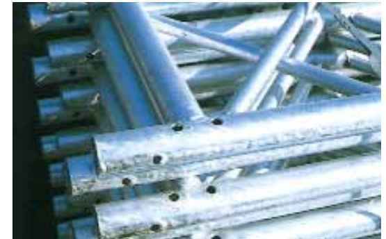
Fig. 1. Acumulación de zinc en los extremos de los tubos en una construcción tubular
