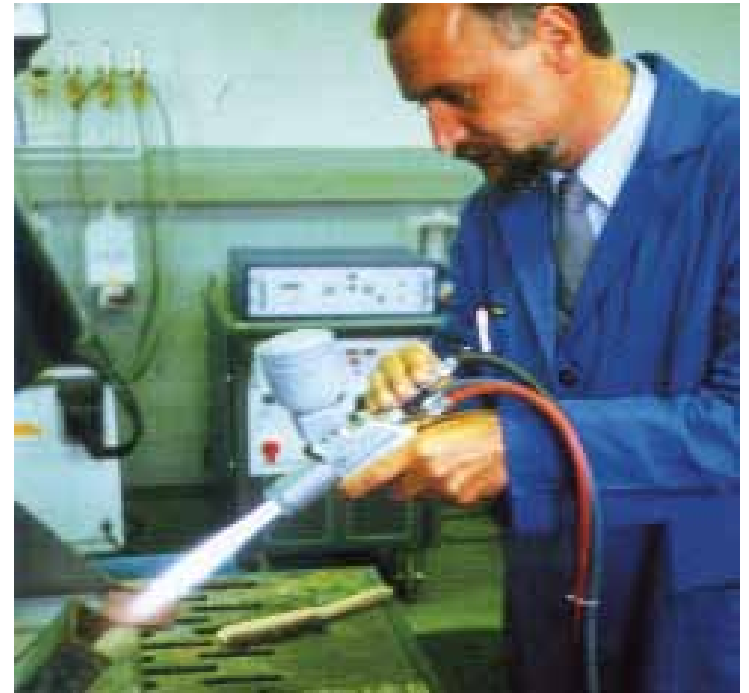
Fig. 5. Restauración mediante proyección térmica de zinc.
