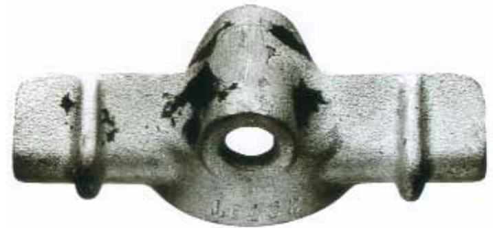
Fig. 2: Defectos en el recubrimiento galvanizado como consecuencia de imperfecciones superficiales en la pieza de fundición (restos de arena de moldeo).
