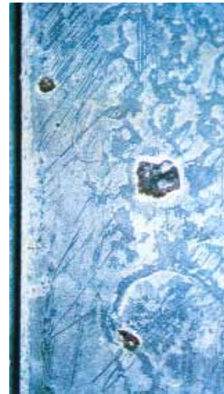
Fig. 3: Protección catódica de las zonas desnudas proporcionada por los recubrimientos de zinc.
