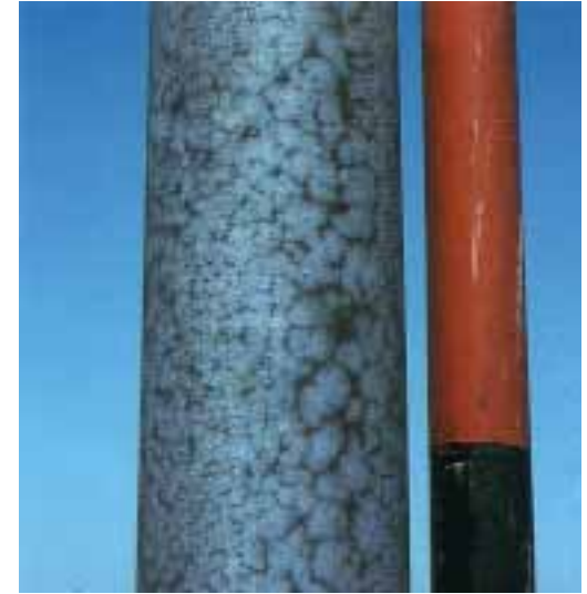
Figura 4: Recubrimiento de aspecto gris mate no uniforme (reticular)
