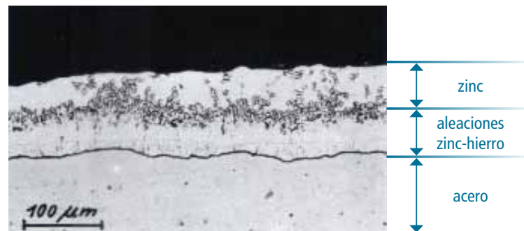
Figura 1: Micrografía de un corte transversal de un recubrimiento galvanizado normal.
