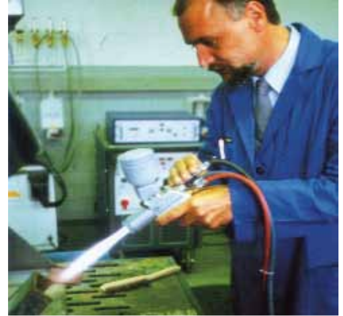
Figura 4: Reacondicionamiento mediante proyección térmica de zinc.
