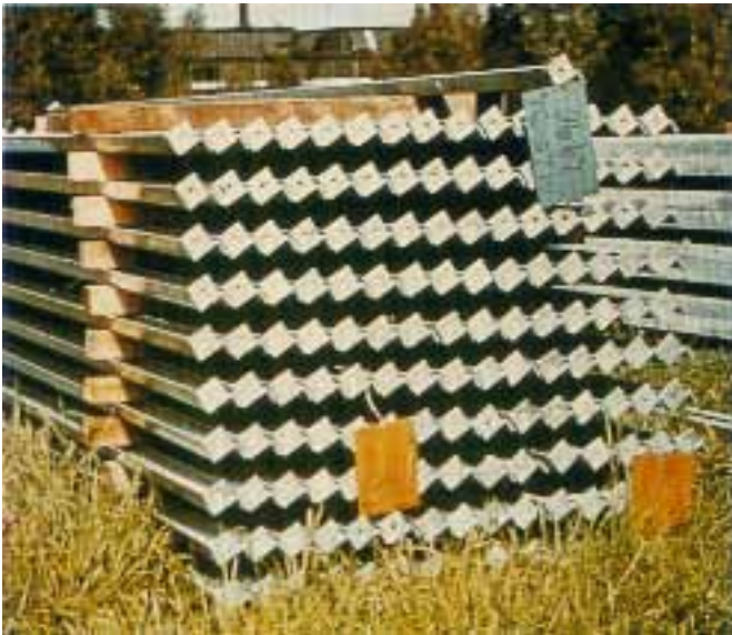
Fig. 3: Almacenamiento incorrecto. Aunque se han colocado separadores de madera entre los diferentes perfiles del paquete, éstos han sido situados con su parte cóncava hacia arriba, por lo que acumularán agua de lluvia y humedad. Por otra parte, los paquetes descansan directamente sobre la hierba húmeda.
